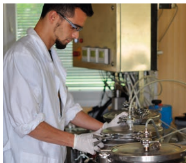
Szilárd fázisú fermentorok üzembe helyezése
